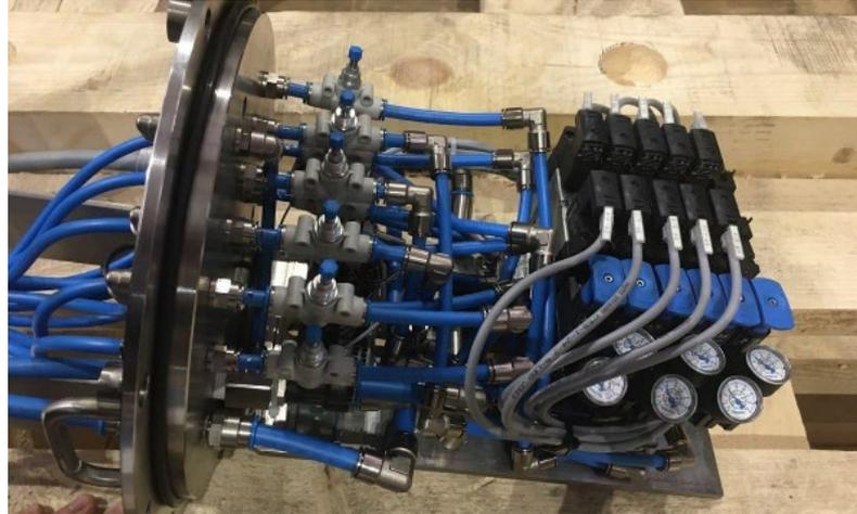
Рисунок 2.15 – Пневматический остров с герметичной крышкой
