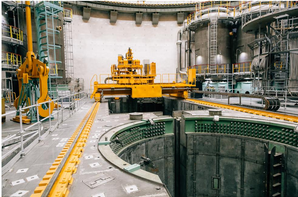
Рисунок 1.3 – Перегрузочная машина в реакторном зале Нововоронежской АЭС
