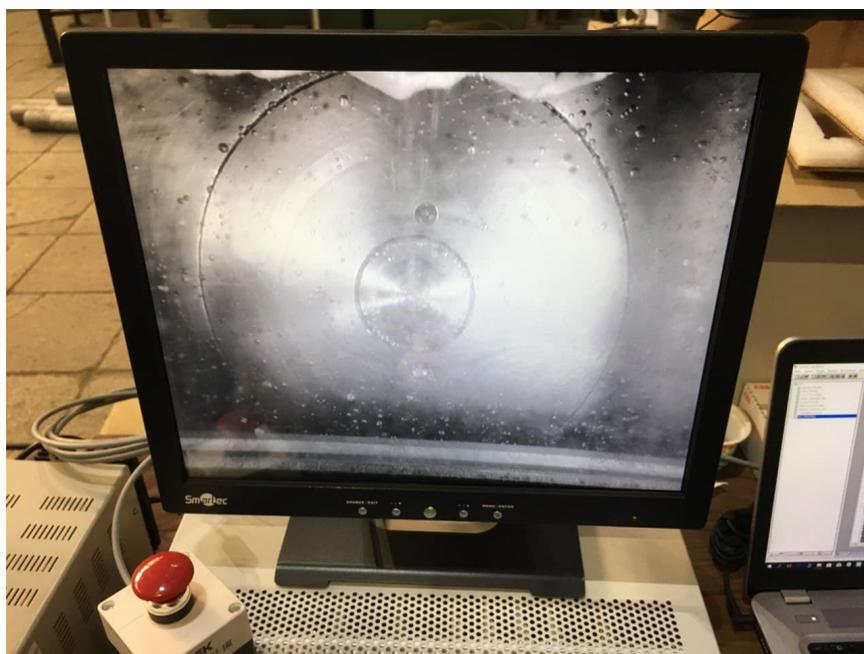
Рисунок 2.14 – Изображение с радиационно-устойчивой камеры при поиске течи
