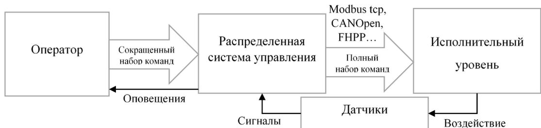
Рисунок 4.12 – Схема информационного обмена устройства
