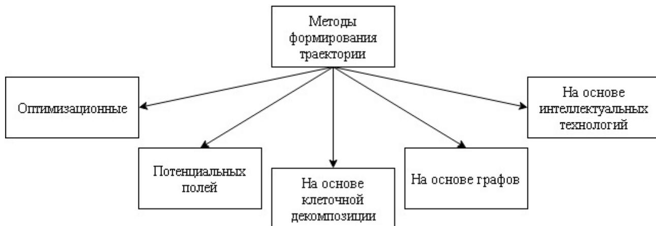
Рисунок 3.1 – Пример классификации методов формирования траектории [65]
